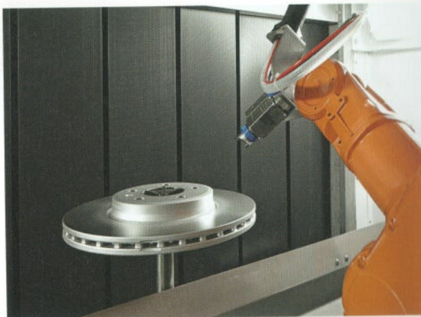
Feine Düse: Bei partiell beschichteten Bremsscheiben wird auf eine schützende Maskierung verzichtet.
