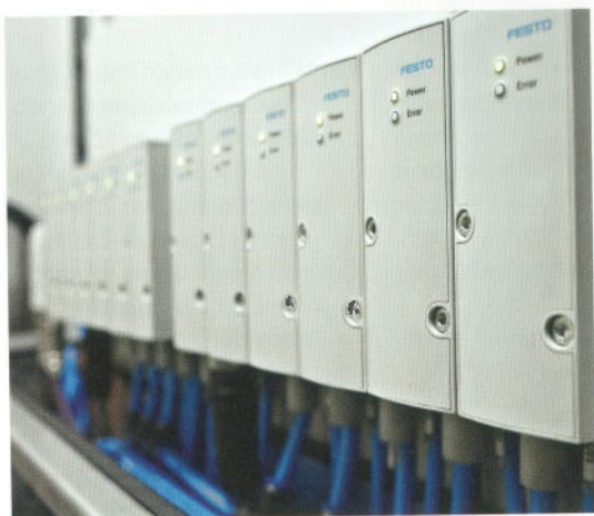
Kraftvoller 12-Ventiler: Ein Dutzend Festo Proportionalventile VPPM regeln präzise den Sprühdruck.
