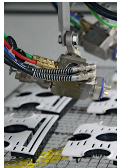
Exakte Beschichtung der Kunststoffteile mit Hochglanzlack
