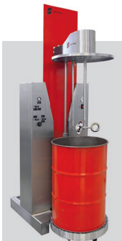
Das pneumatische Deckel-Hubwerk erleichtert den Austausch der Lackfässer.
