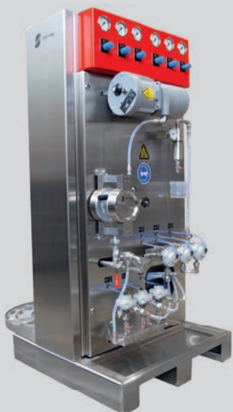
Durch die verschiedenen Reglerkreisläufe kann z.B. die Schichtdicke am Dosenboden unabhängig von der Schichtdicke an der Dosenwandung verändert werden.
